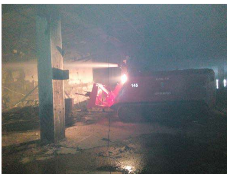
Рис. 6. Тушение пожара с применением РТК Ель-10 в дистанционном режиме на участке № 2
