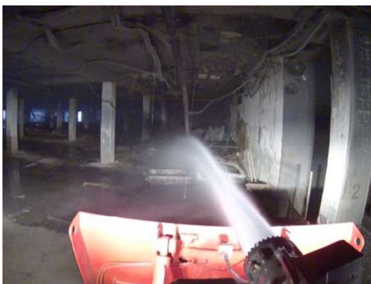
Рис. 7. Тушение пожара с применением РТК Ель-10 в дистанционном режиме на участке № 4
