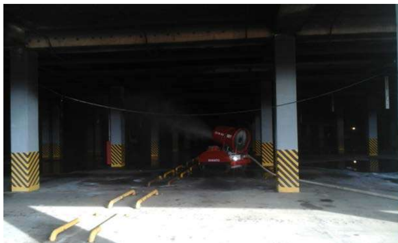
Рис. 8. Тушение пожара с применением РТК Луф-60 в дистанционном режиме на участке № 4
