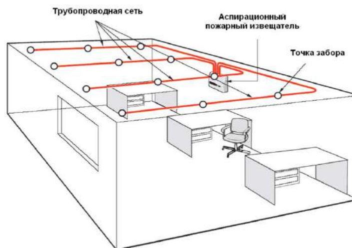
Рис. 8. Конструкция аспирационного дымового пожарного извещателя
