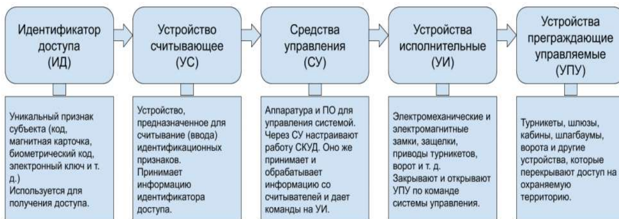
Рис. 1. Принципиальная схема СКУД
