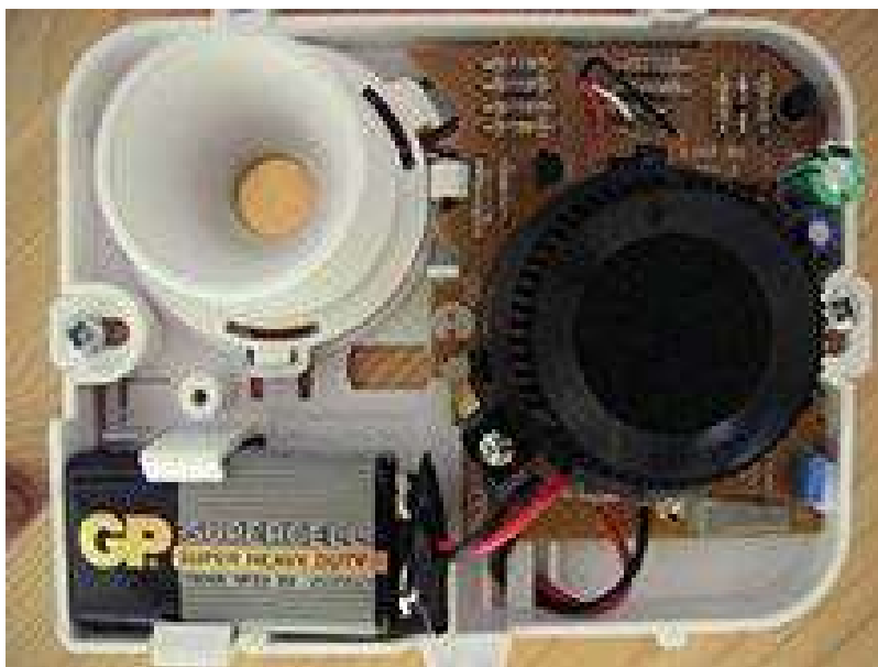
Рис. 2. Радиоизотопный дымовой пожарный извещатель SmokeGard-700 Справа размещена ионизационная камера с радиоактивным материалом. Слева сверху установлена пьезоэлектрическая сирена
