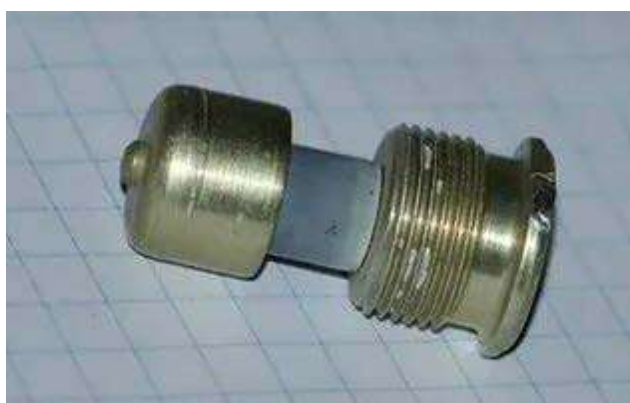
Рис. 3. Радиоактивный элемент из пожарного извещателя РИД-1
